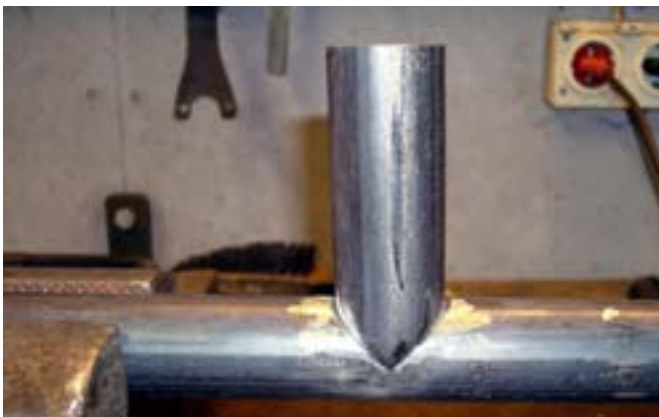
Inskarvning av rör.
