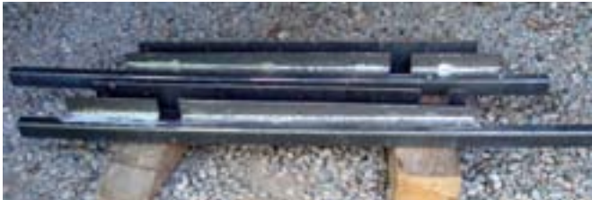
Rocksliders färdiga för komplettering med rör.
