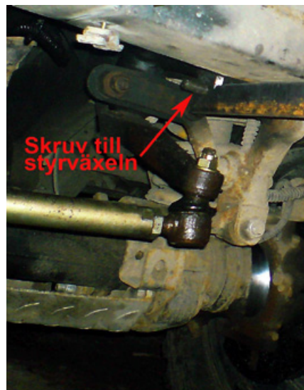
Skruven vid styrväxeln.
